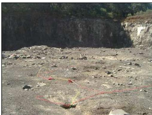
**FIGURA 91- Bancada pronta para o desmonte. Exploração do basalto.**
