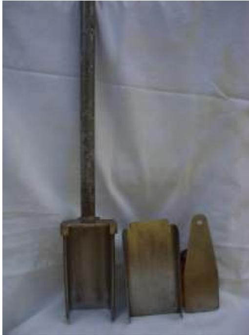
**FIGURA 10** – Trado especial desenvolvido pelo autor, composto de 3 partes (1- trado com pá de corte; 2 – tampa da amostra indeformada; 3- espátula de apoio.
