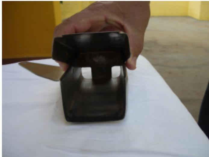
**FIGURA 11** – Trado especial montado para realizar a coleta, consta de uma caixa em que fica a amostra de terra de forma indeformada.
