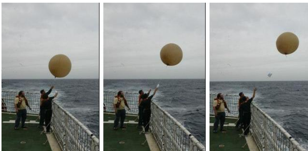
Figura 3.2 - Operação de lançamento de radiossondas atmosféricas realizado em novembro de 2004 a bordo do NApOc Ary Rongel.
