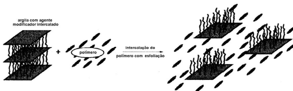
**Figura IV.7-** Esquema de estruturas de compósitos obtidos usando argilas laminadas. As barras retangulares representam as camadas de argila.
