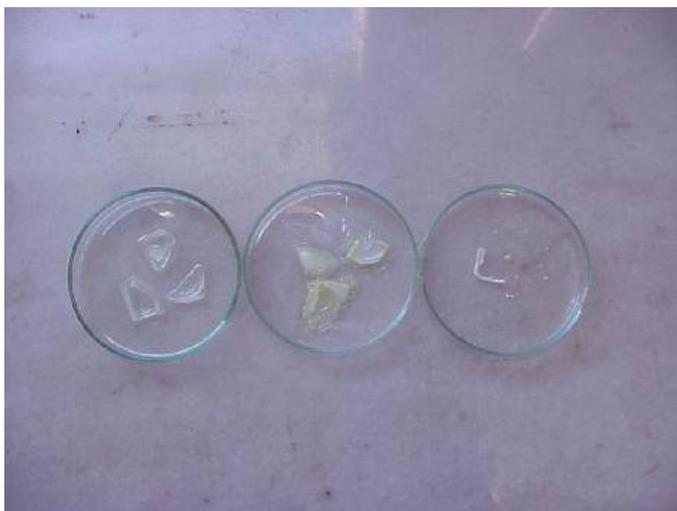
**Figura VI.7-** *Aspecto de filmes de poliuretano puro após 24h de hidrólise em solução NaOH (3%). Da esquerda para a direita: PUD-1, PUD-5, PUD-7.*
