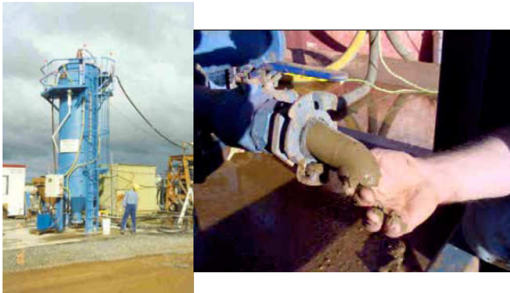
Figura 3.4: Espessador de cone profundo piloto e detalhe da descarga de pasta. (GL&V, 2003)
