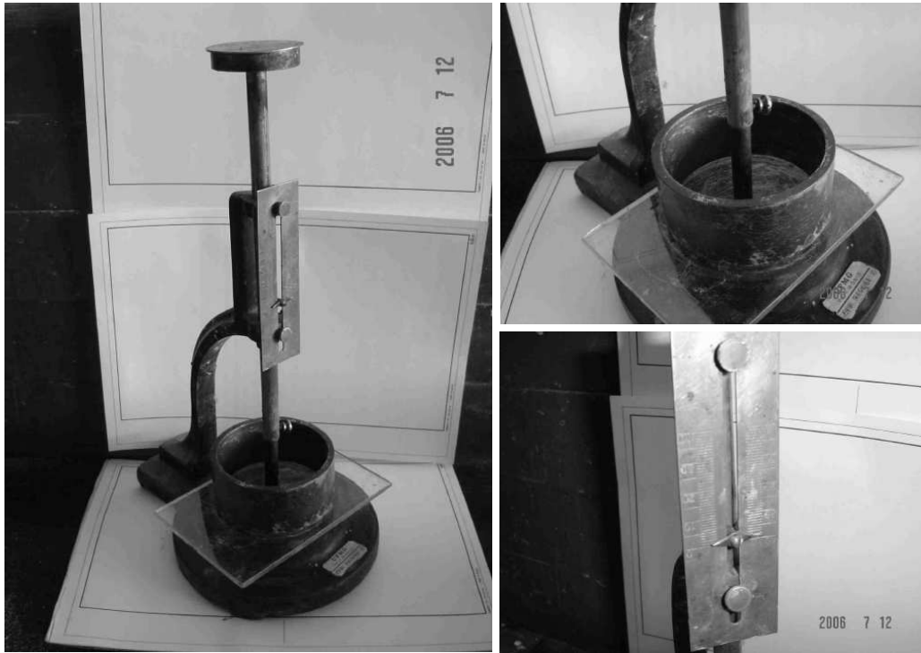
Figura 4.10: Aparelho de Vicat usado para determinar a consistência das pastas minerais.
