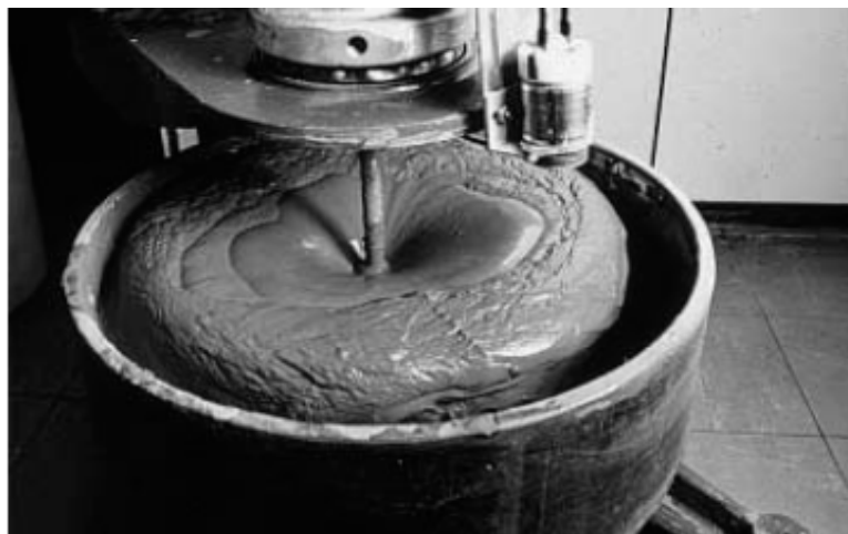
Figura 4.3: Reômetro usando técnica de Vane para medições da tensão de escoamento. (Jewell, 2003)
