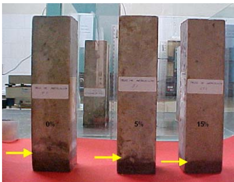
Figura 5. 14 – Detalhe das amostras de concretos, após 7 dias de realização do ensaio de absorção de água por capilaridade.
