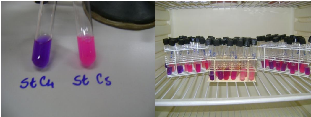
Figura 14: Ensaio da determinação da Concentração Inibitória Mínima
