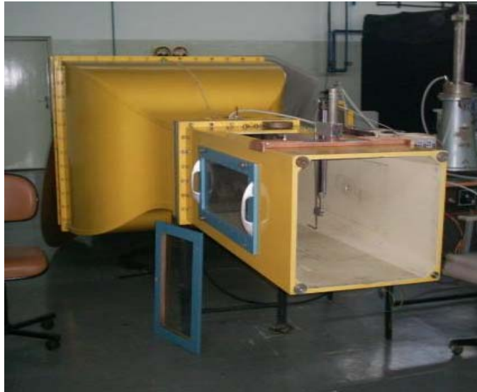
Figura 3.7 – Túnel de vento do laboratório Prof. Kwein Lien Feng (ITA) utilizado nos experimentos da tese.
