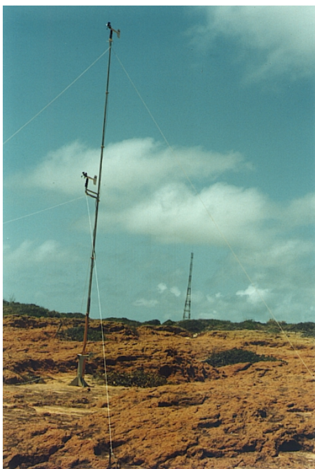
Figura 3.4 - Anemômetros B – 4,5 e 9,0 m de altura, a 50 m da falésia
