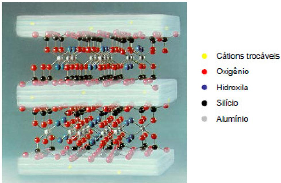
Figura 2.2: Representação esquemática da estrutura do argilomineral montmorilonita. Fonte: Amorim (2003) *apud* Valenzuela Diaz (2003).
