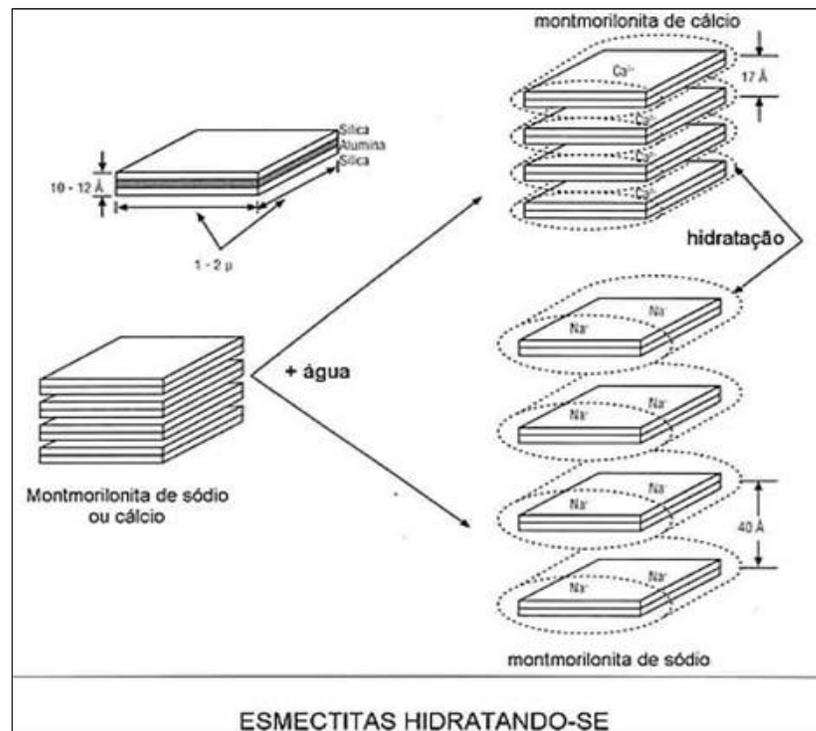
Figura 2.3: Hidratação da montmorilonita cálcica e da montmorilonita sódica. Fonte: Lummus & Azar (1986).
