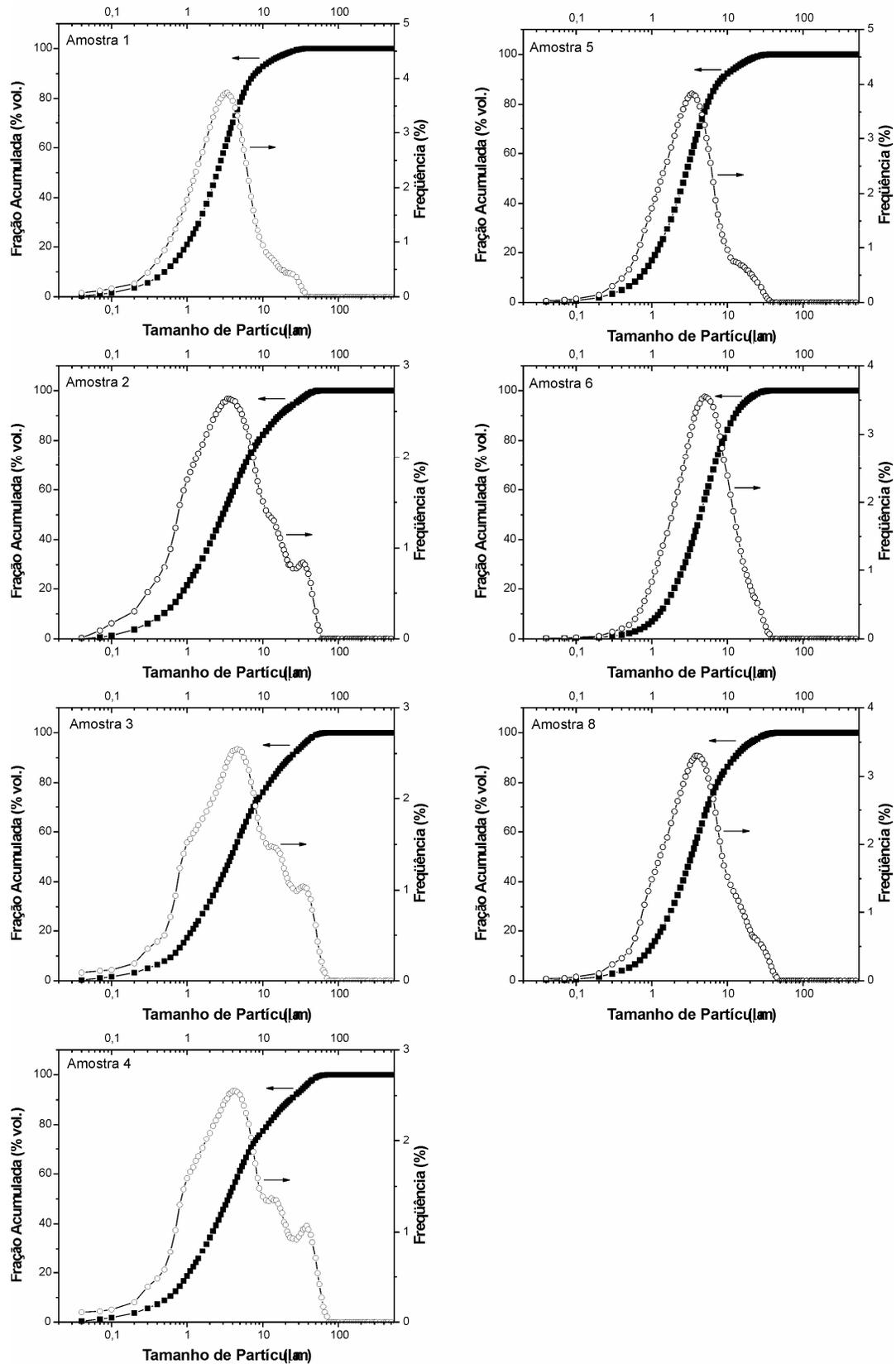
Figura 4.1: Distribuição do tamanho de partículas das amostras analisadas.
