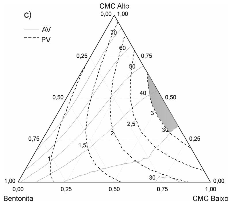
Figura 4.9 (continuação): Intersecção das superfícies de resposta da viscosidade aparente (VA) e viscosidade plástica (VP) evidenciando as regiões composicionais onde: a) as dispersões da amostra 1 possuem  $VA \geq 30$  cP e  $VP \geq 4,0$  cP, b) as dispersões da amostra 3 possuem  $VA \geq 30$  cP e  $VP \geq 3,5$  cP e c) as dispersões da amostra 4 possuem  $VA \geq 30$  cP e  $VP \geq 3,5$  cP.
