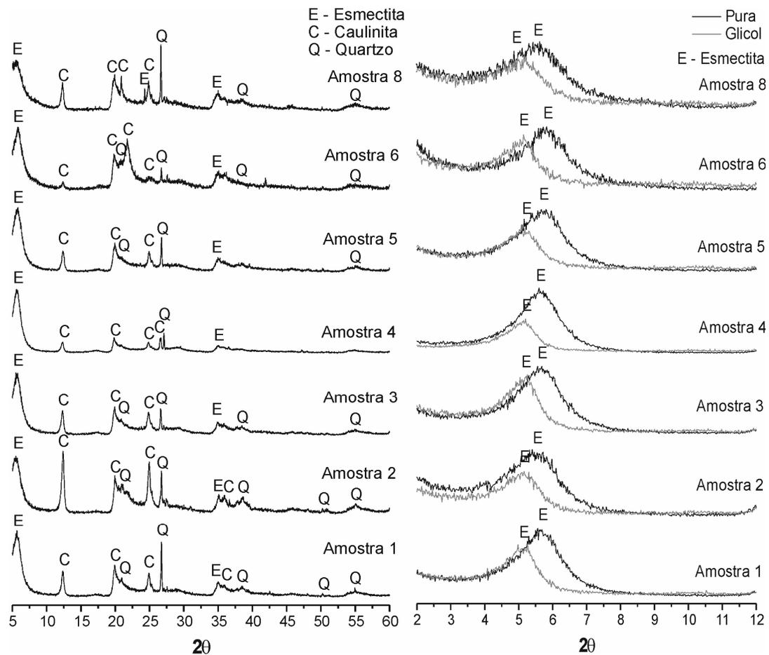
Figura 4.2: Difração de raios X das amostras analisadas.
