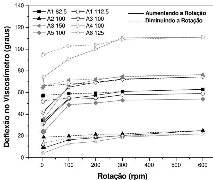
Figura 4.6: Curvas de fluxo das dispersões analisadas.
