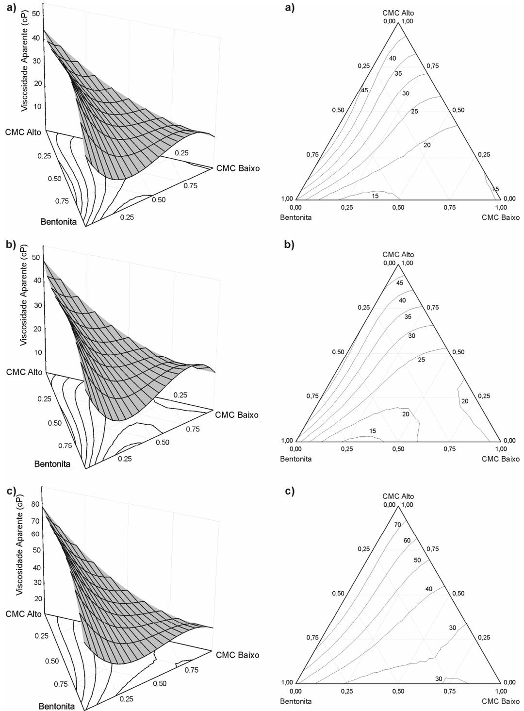
Figura 4.7: Superfície de resposta e sua projeção no triângulo de composições para a viscosidade aparente das dispersões preparadas com: a) amostra 1, b) amostra 3, c) amostra 4.
