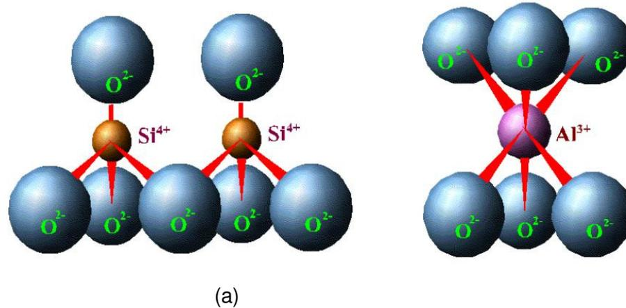
Figura 2.1: Representação esquemática da folha de silicato tetraédrica (a) e da folha central octaédrica da estrutura do argilomineral montmorilonita (b). Fonte: Amorim, (2003) *apud* Valenzuela Diaz (2003).
