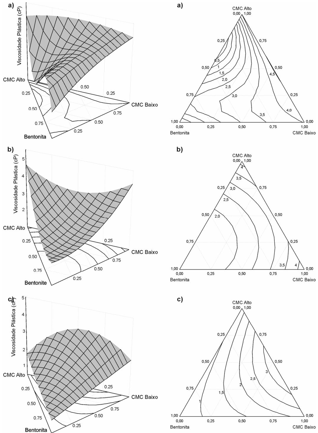
Figura 4.8. Superfície de resposta e sua projeção no triângulo de composições para a viscosidade plástica das dispersões preparadas com: a) amostra 1, b) amostra 3, c) amostra 4.
