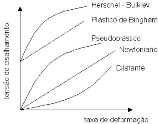
Figura 2.4: Curvas de escoamento de fluidos Newtonianos e não-Newtonianos de propriedades independentes do tempo de cisalhamento. Fonte: [http://www.setor1.com.br/analises/reologia/curva\\_inde.htm](http://www.setor1.com.br/analises/reologia/curva_inde.htm)
