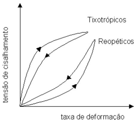
Figura 2.5: Curvas de escoamento de fluidos não-Newtonianos de propriedades dependentes do tempo de cisalhamento. Fonte: [http://www.setor1.com.br/analises/reologia/curva\\_depe.htm](http://www.setor1.com.br/analises/reologia/curva_depe.htm)
