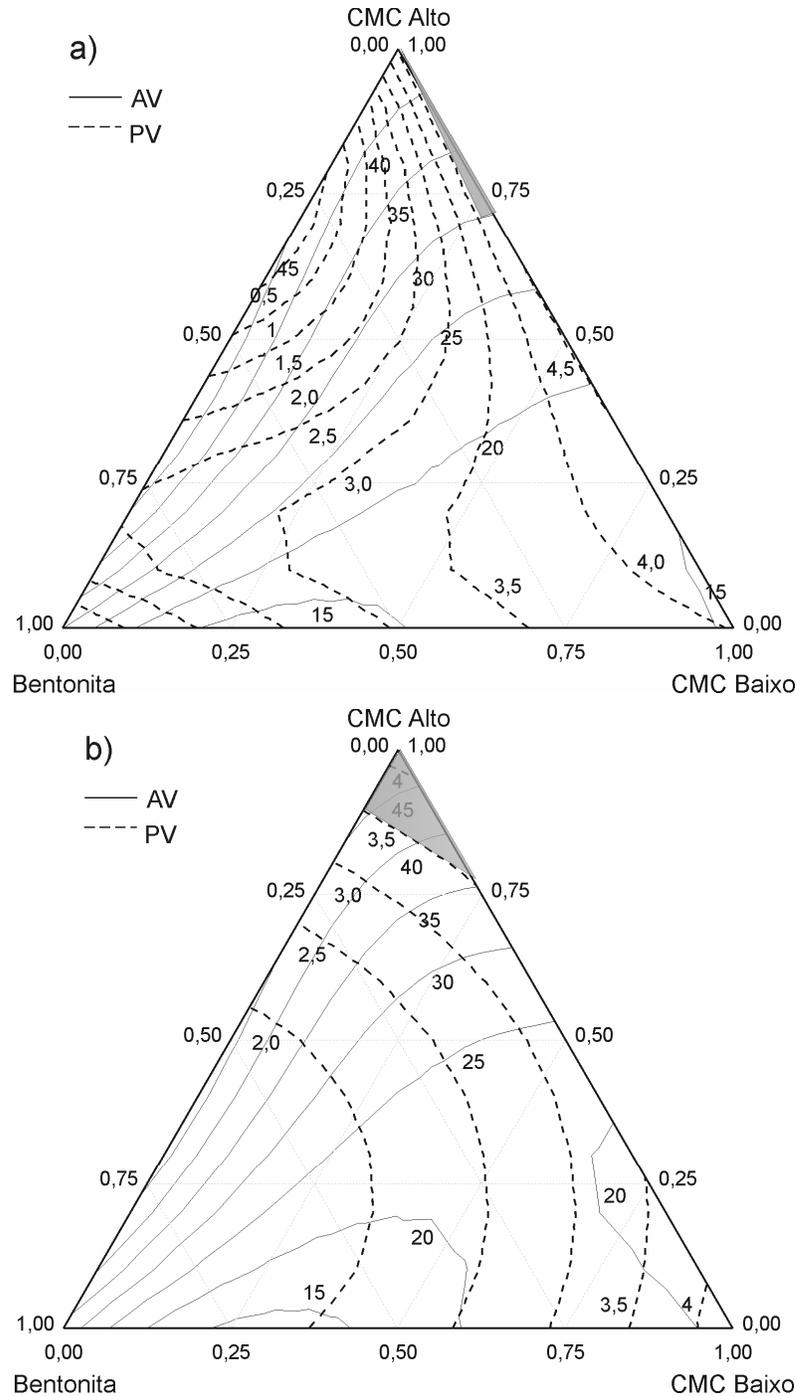
Figura 4.9: Intersecção das superfícies de resposta das viscosidades aparente (VA) e viscosidade plástica (VP) evidenciando as regiões composicionais onde: a) as dispersões da amostra 1 possuem  $VA \geq 30$  cP e  $VP \geq 4,0$  cP, b) as dispersões da amostra 3 possuem  $VA \geq 30$  cP e  $VP \geq 3,5$  cP e c) as dispersões da amostra 4 possuem  $VA \geq 30$  cP e  $VP \geq 3,5$  cP.
