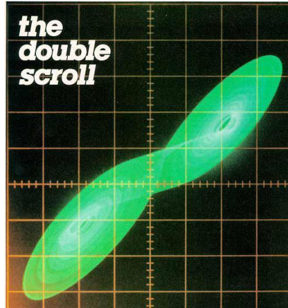
Figura 2.3: Primeiro atrator caótico em formato Duplo-Rolo obtido experimental para o circuito de Chua, em 1985, apresentado por Takashi Matsumoto, Leon O. Chua, e Motomasa Komuro no artigo "The Double Scroll" (7) .
