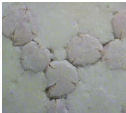
FIGURA 23 – IMAGEM SUPERFICIAL DO COMPRIMIDO CONTENDO PÉLETES REVESTIDOS A 10%
