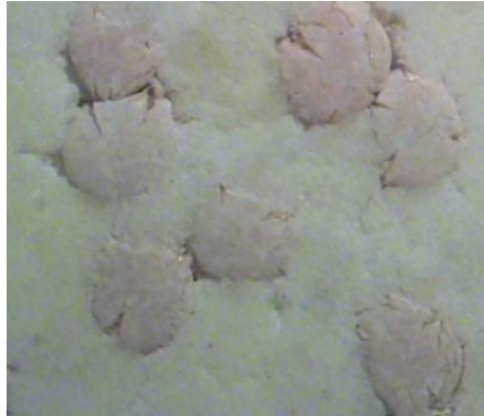
FIGURA 21 – IMAGEM SUPERFICIAL DO COMPRIMIDO CONTENDO PÉLETES REVESTIDOS A 8%
