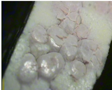
FIGURA 22 – IMAGEM LATERAL DO COMPRIMIDO CONTENDO PÉLETES REVESTIDOS A 10%
