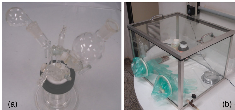
Figura 11 - (a) Sistema reacional desenvolvido para a síntese dos derivados do politiofeno em atmosfera inerte de N_2 . (b) Glove box utilizada para manuseio dos reagentes em atmosfera inerte de N_2 .
