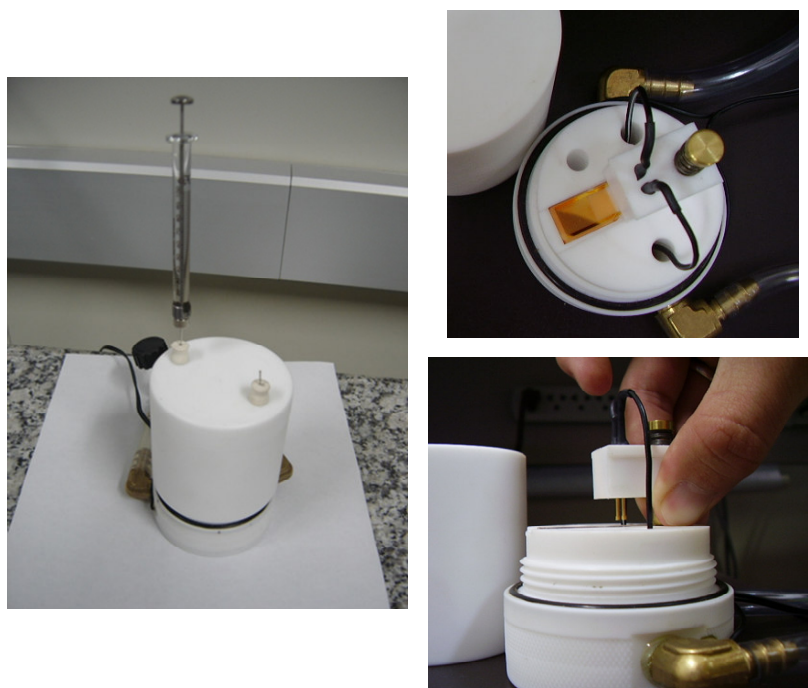
Figura 38 - Câmara de ensaio estático para o estudo dos sensores elétricos.
