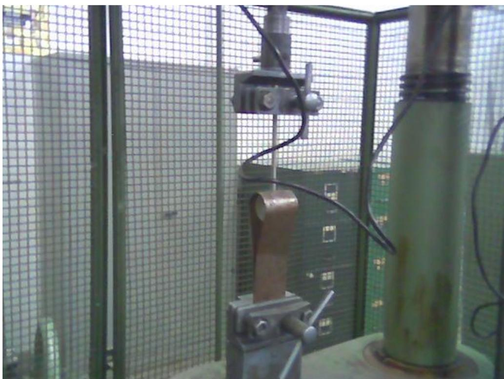
Figura 4 – Corpo de prova constituído por um tubo de polipropileno e um pino de Schanz a ele fixado, montados na máquina universal de ensaios WPM - ZD100PU para a realização de teste de resistência à tração.
