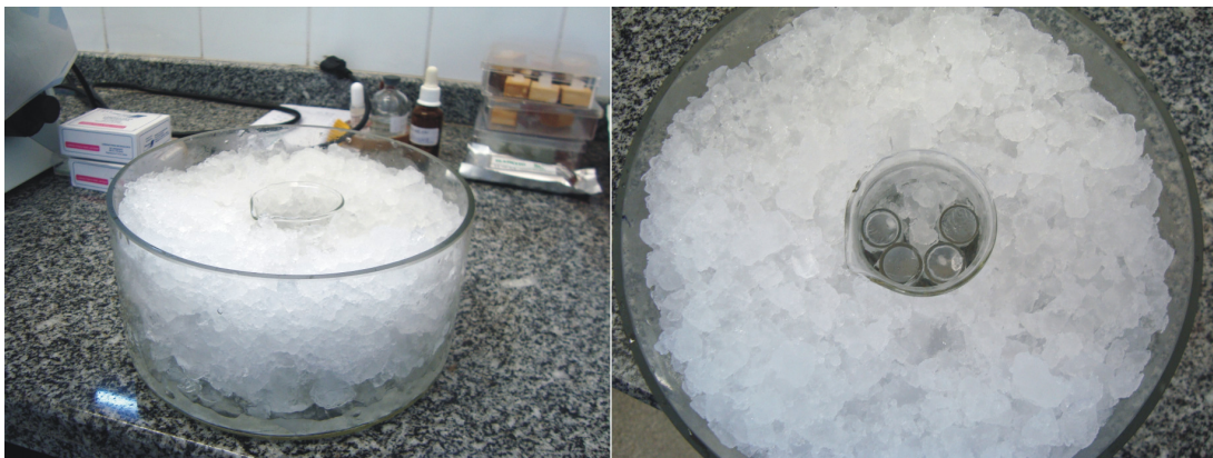
Figura 3.1. Cuba de gelo contendo amostras de cabeças de Nezara viridula imersas em EDTA 7% para irradiação por micro-ondas.
