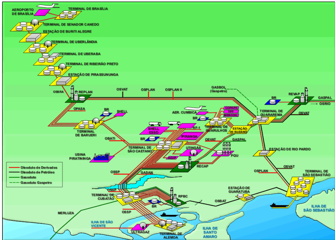
Figura 1 – Malha de dutos da região Centro-Oeste e São Paulo (figura fornecida pela PETROBRAS)
