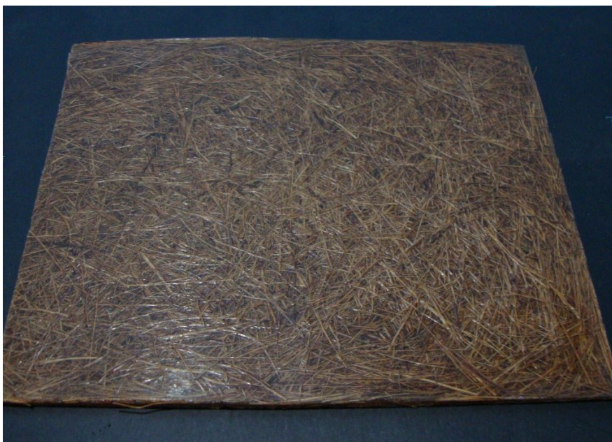
Figura 3.2 – Chapa típica de um compósito epóxi-fibra de coco com 30% de fibra.
