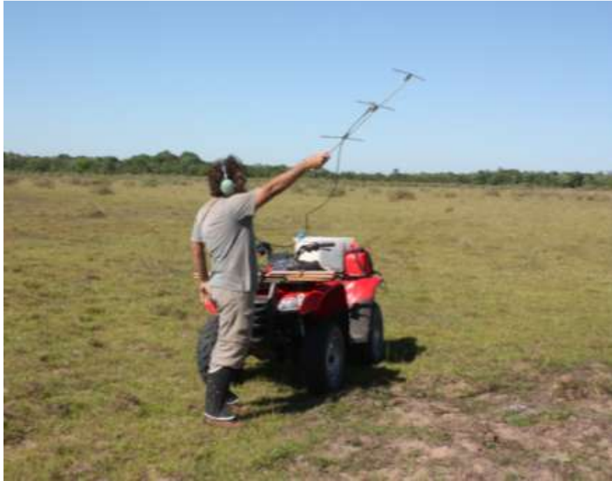
Figura 11 – Pesquisador utilizando equipamento de receptor de sinais de colares radiotransmissores (Telonics TR2) no Pantanal.
