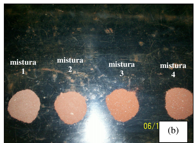
Figura 5.5 – Materiais: (a) Pó de micaxisto, fíler de micaxisto e solo fino; (b) Misturas utilizados no trecho.
