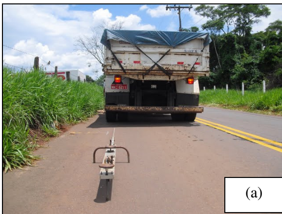
Figura 5.11 – Execução do ensaio de Viga Benkelman: (a) posicionamento do caminhão; (b) anotação das leituras.
