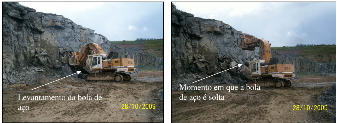
Figura 6.2 – Dispositivo drop all fragmentando os blocos maiores.
