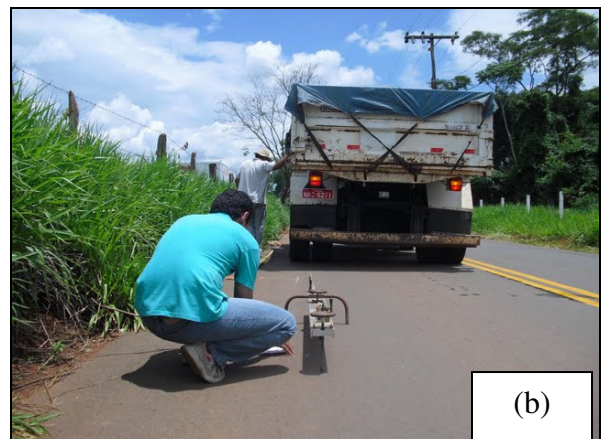
Figura 5.11 – Execução do ensaio de Viga Benkelman: (a) posicionamento do caminhão; (b) anotação das leituras.
