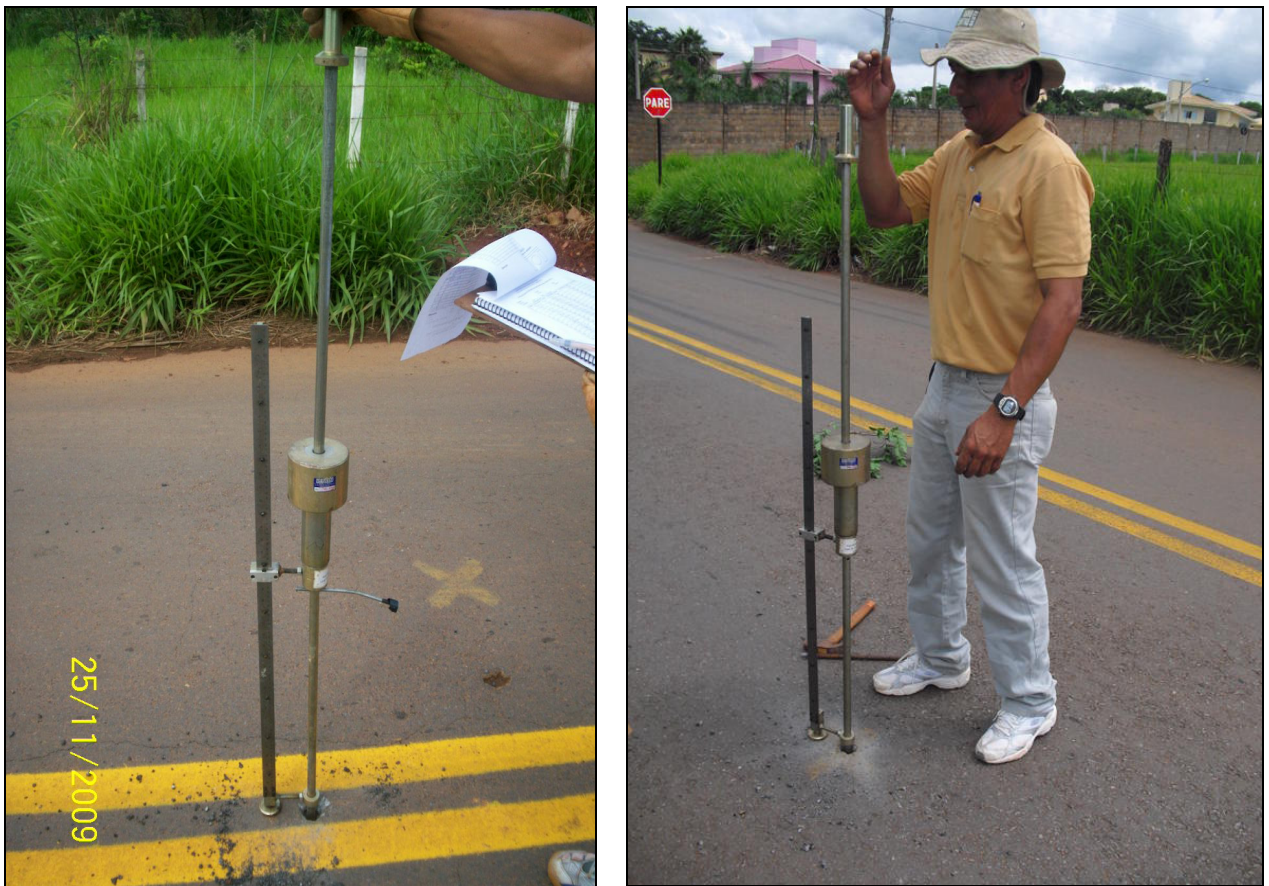
Figura 5.9 – Execução do ensaio: (a) Equipamento (DCP); (b) execução do ensaio.
