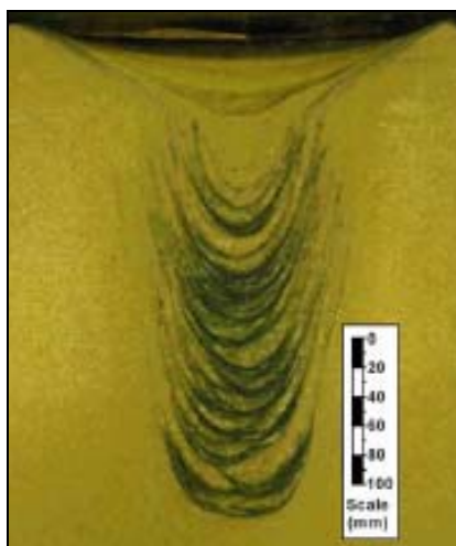
Figura 2.18: Fotografia de uma barreira reativa de ZVI instalada através da técnica de fluidização em um tanque preenchido com areia (Niven, 2001).
