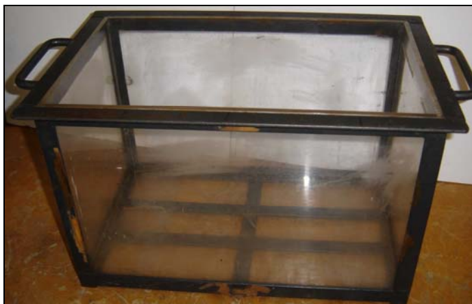
Figura 3.4: Tanque retangular com paredes em acrílico.
