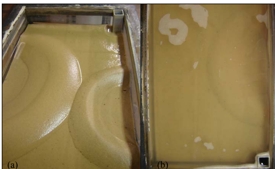
Figura 4.5: Vista superior da duna, após término do ensaio: (a) sem lâmina de água; (b) com lâmina de água.
