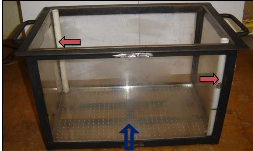
Figura 3.5: Tanque acrílico, chapa acrílica perfurada (indicada pela seta vertical) e tubos de PVC (indicados por setas horizontais).
