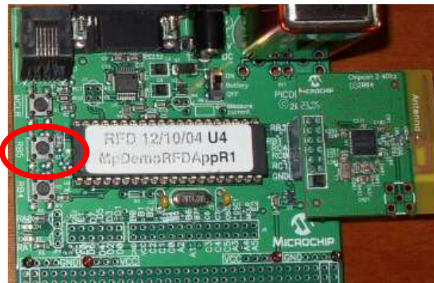
Figura 85 – Botão RB5 do dispositivo RFD (Placa eletrônica de desenvolvimento PICDEM™ Z)
