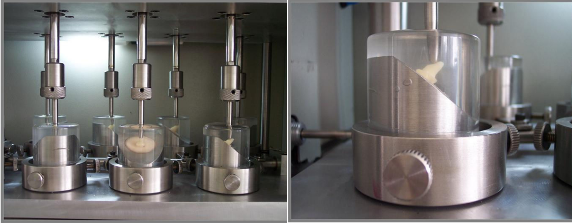
Figura 5- Máquina de ciclagem mecânica contendo 10 estações.
