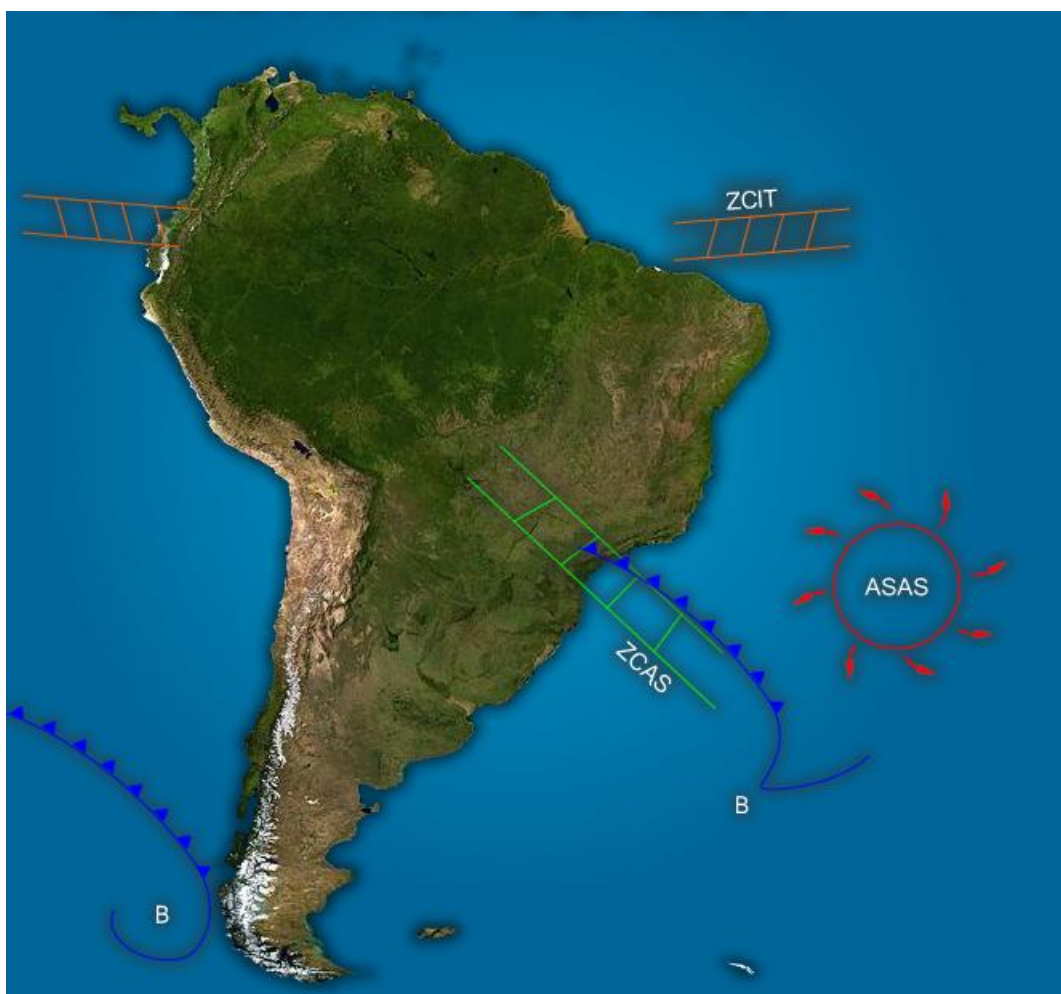
Figura 2.3 - Representação dos sistemas atmosféricos presentes na baixa troposfera, que atuam sobre a América do Sul durante o verão. Alta Subtropical do Atlântico Sul (ASAS); Zona de Convergência do Atlântico Sul (ZCAS); Zona de Convergência Intertropical (ZCIT); Baixa pressão associada aos sistemas frontais (B).
