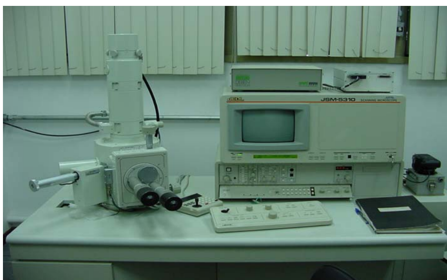
Figura 3.4 - Microscópio Eletrônico de Varredura JEOL, modelo JSM 5310, instalado no Laboratório Associado de sensores e materiais (LAS) – INPE, São José dos Campos.
