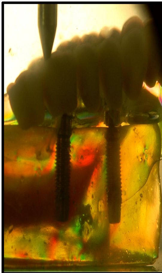
Figura 3 - Aplicação de carga no modelo fotoelástico com sistema de retenção o'ring (Grupo III).
