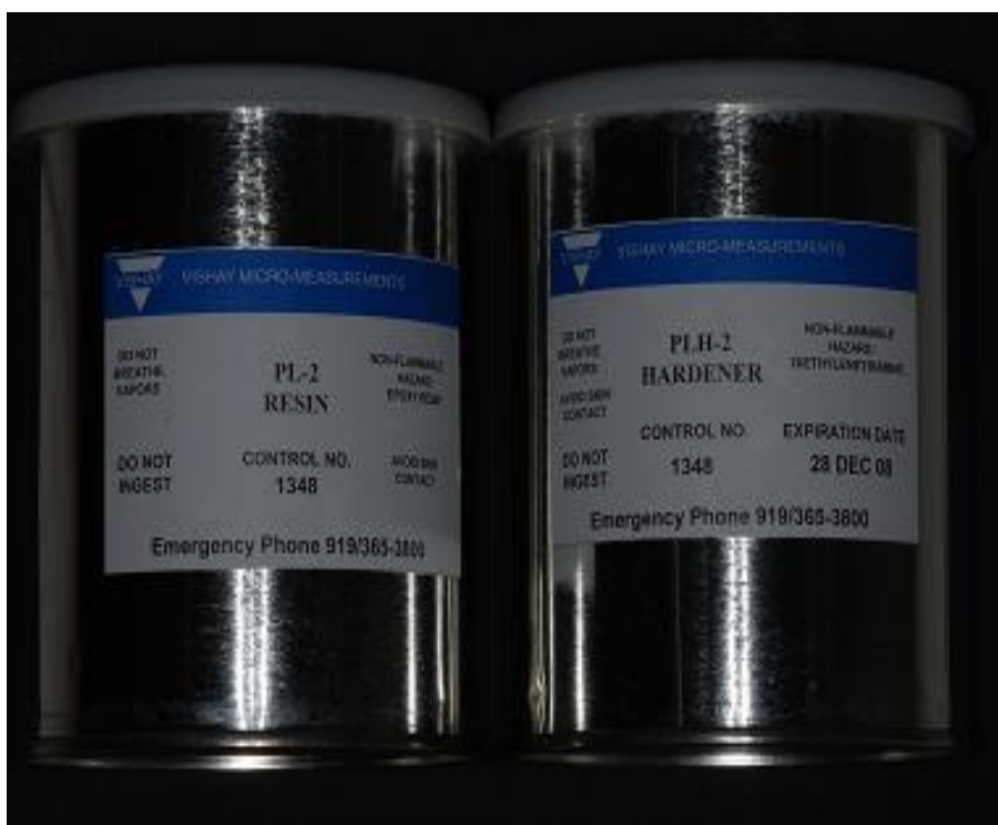
Figura 8 - Resina fotoelástica PL-2 (Vishay Measurements Group, Inc Raleigh, N.C., USA).
