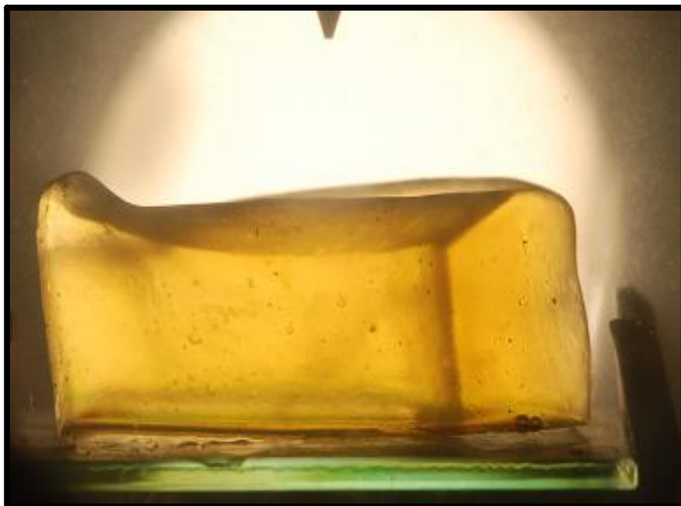
Figura 20 - Modelo fotoelástico livre de tensões iniciais.
