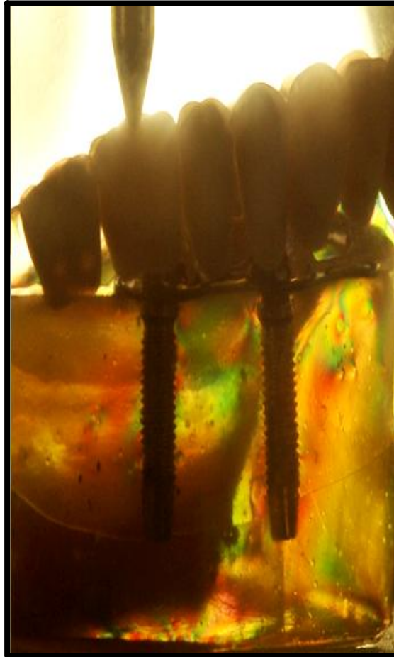
Figura 4 - Aplicação de carga no modelo fotoelástico com sistema de retenção barra clipe (Grupo IV).
