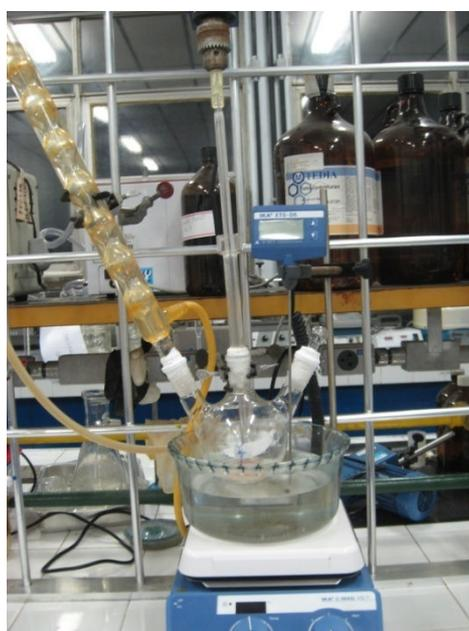
Figura 29 – Sistema para produção de biodiesel
