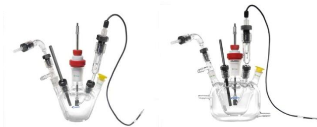
FIGURA 2.5 - Modelos de células eletroquímicas da Gamry Instruments .
