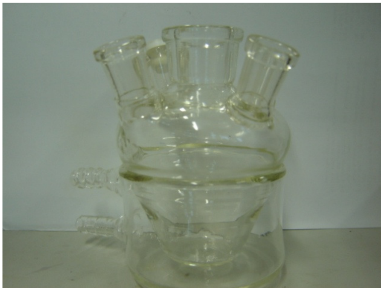
Figura 15: Célula eletroquímica utilizada para os experimentos
