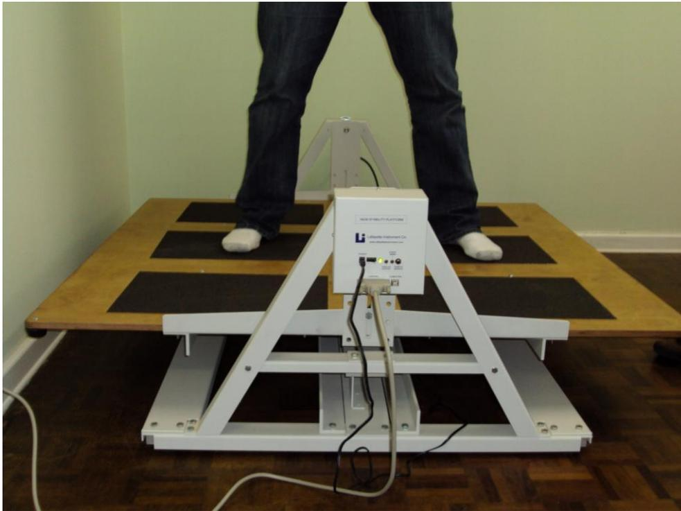
Figura 2: Plataforma de equilíbrio modelo 16030 (Lafayette Instrument).
