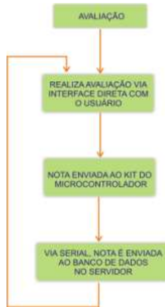
Figura 32 - Diagrama em bloco do processo de votação
