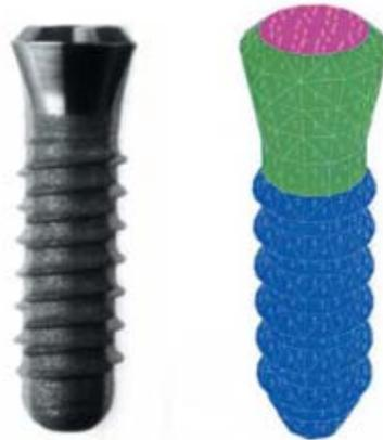
Figura 9– Ilustração da formação de uma malha de elementos finitos, à direita, em um modelo geométrico criado a partir de um implante dentário, à esquerda.
