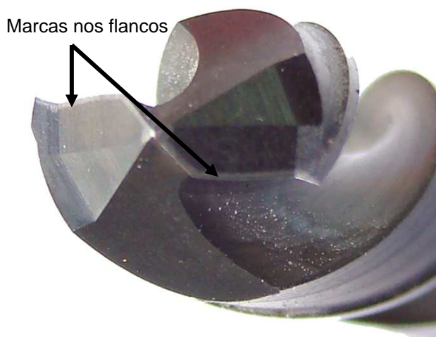
Figura 109 – Marca nos flancos da broca de metal duro, na usinagem de resina epóxi com carga metálica.
