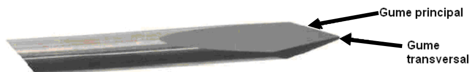
Figura 6 – Broca tipo dagger com dois gumes principais e gume transversal reduzido (DURÃO et al, 2006).
