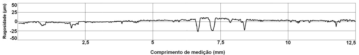
Figura 53 – Perfil de rugosidade da superfície da parede do furo, após ensaio de furação, da resina epóxi com 0% de carga metálica e v_c de 50 m/min.
