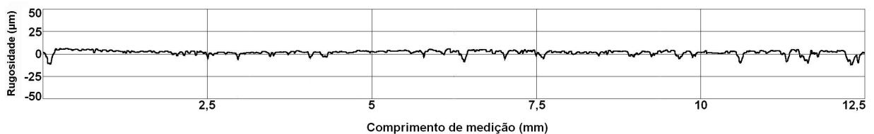
Figura 85 – Perfil de rugosidade da superfície da parede do furo, após ensaio de furação, da resina epóxi com 30% de carga metálica e v_c de 50 m/min.
