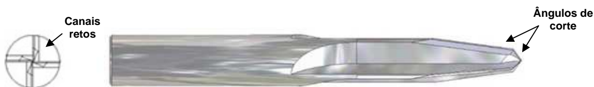
Figura 7 – Broca tipo one shot com canais retos e dois ângulos de corte no gume principal (FERNANDES; COOK, 2006).
