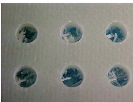
Figura 21 – Efeito de delaminação na furação de material compósito com carga de fibras (ARAÚJO; ABRÃO; FÁRIA, 2005).
