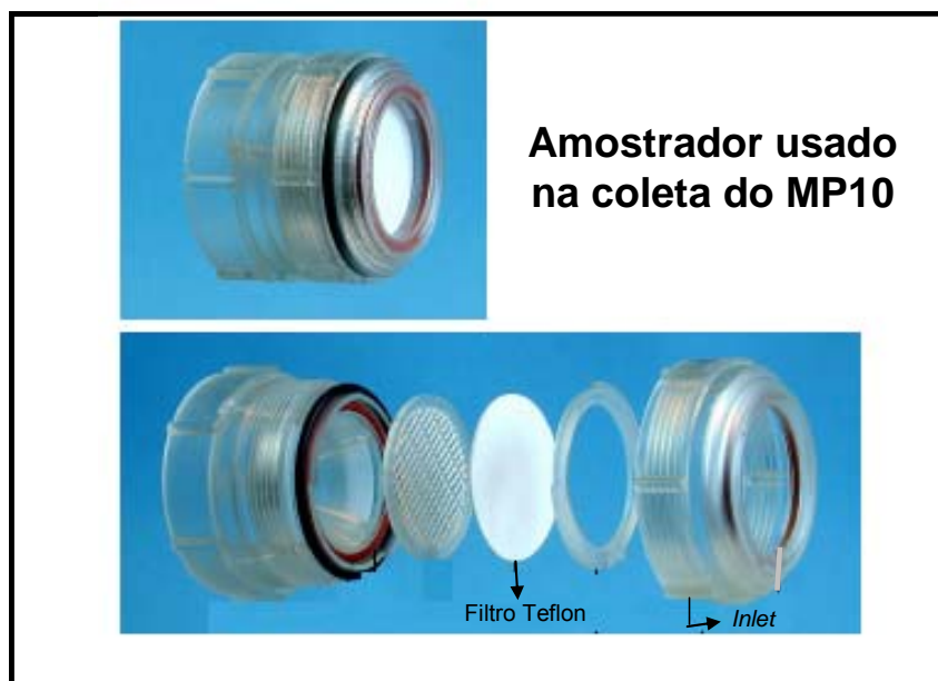
Figura 7: Esquema da montagem do amostrador acoplado com inlet , utilizando filtros teflon (Adaptado de: NILU Products AS, 2010)
