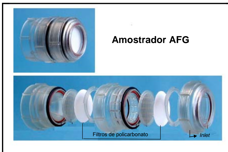
Figura 8: Esquema da montagem do amostrador de particulado fino e grosso (AFG) acoplado com inlet , utilizando filtros de policarbonato (Adaptado de: NILU Products AS, 2010).
