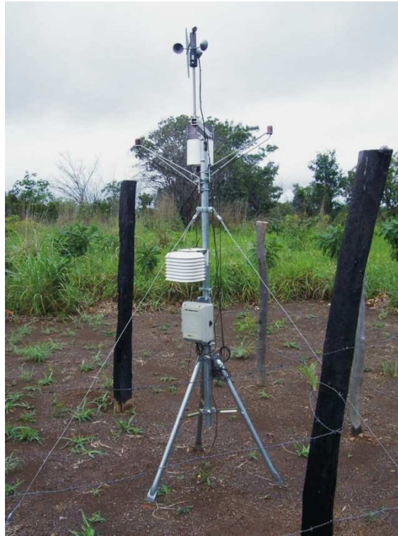
Figura 4.7: Micro-estação meteorológica HOB0.
