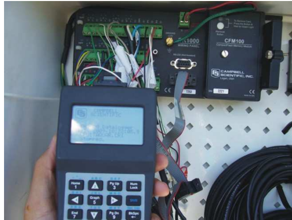
Figura 4.9: Datalogger e coletor de dados da estação Campbell.
