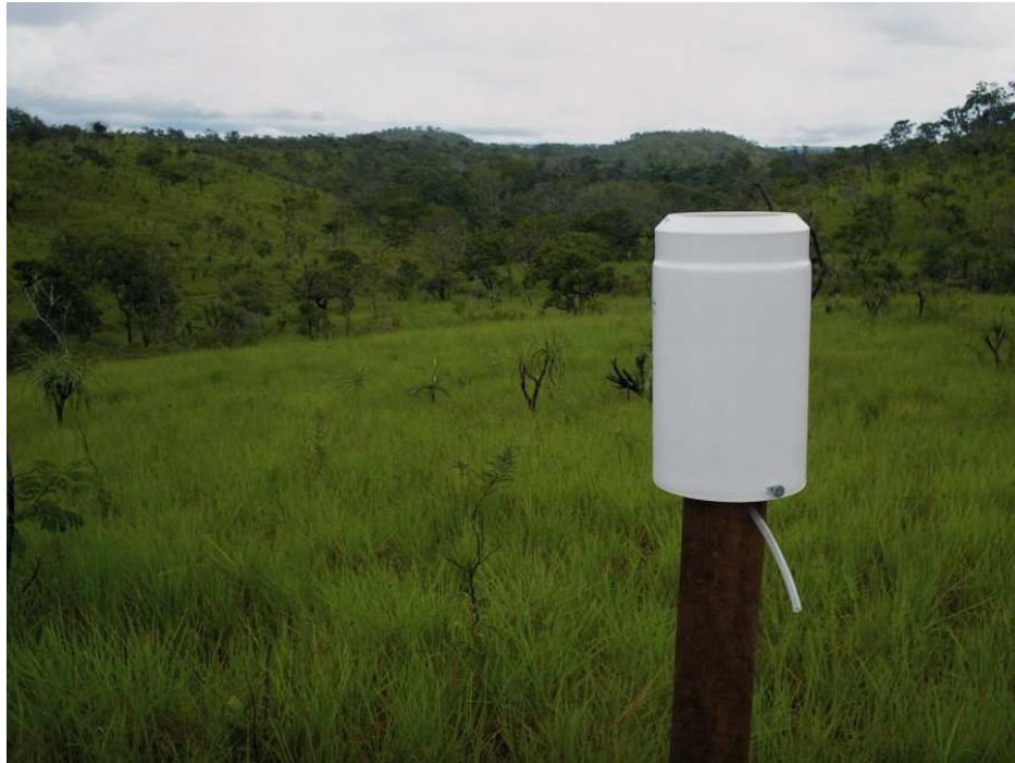
Figura 4.13: Pluviógrafo instalado na área.
