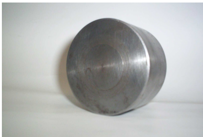
Figura IV.5 – Fonte de nêutrons ^{238}\text{PuBe}(\alpha,n) de 1850 GBq
