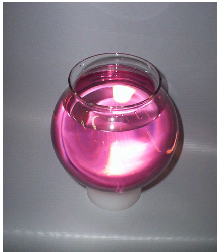
Figura IV.15 – O Arranjo de Irradiação de Teste (AIT) sem meio refletor
