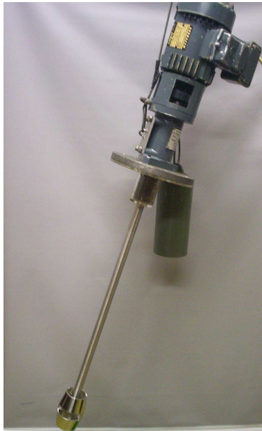
Figura IV.3 – Misturador utilizado para homogeneizar a atividade no BSM
