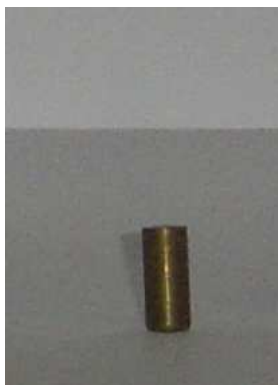
Figura IV.6 – Fonte de nêutrons de ^{252}\text{Cf}(f,n)
