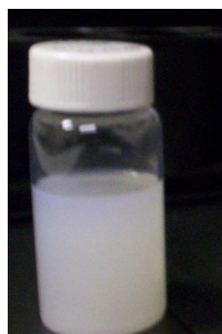
Figura V.12 – Aparência do cintilador líquido Hisafe III com 1 g de solução de \text{MnSO}_4
