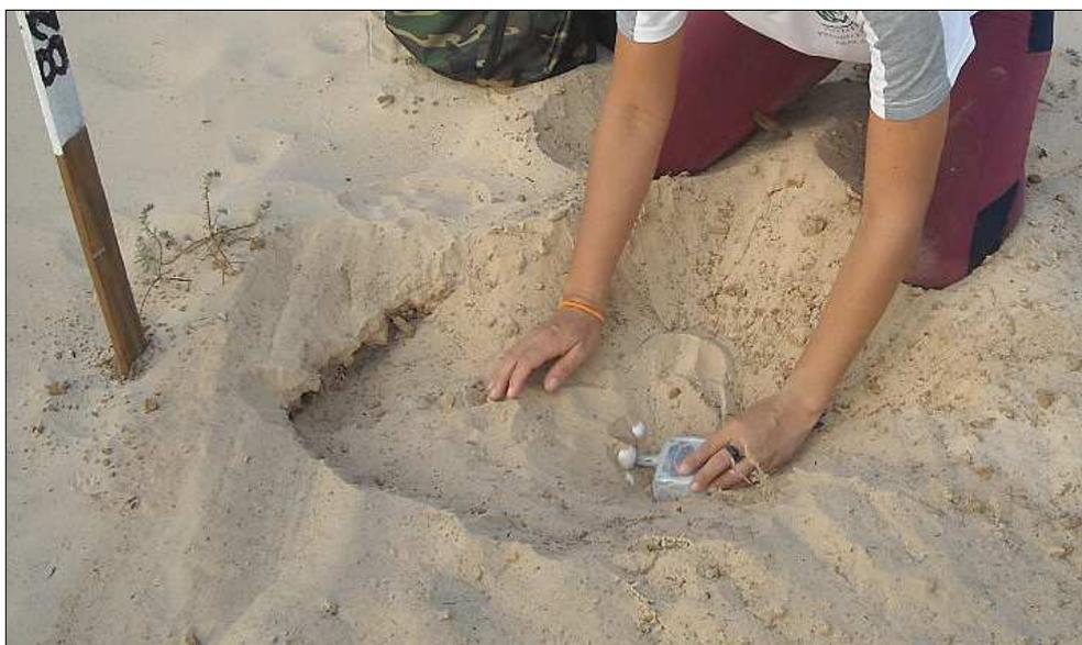
Figura 3. Instalação do registrador automático de temperatura. Foto: Talita Prado.
