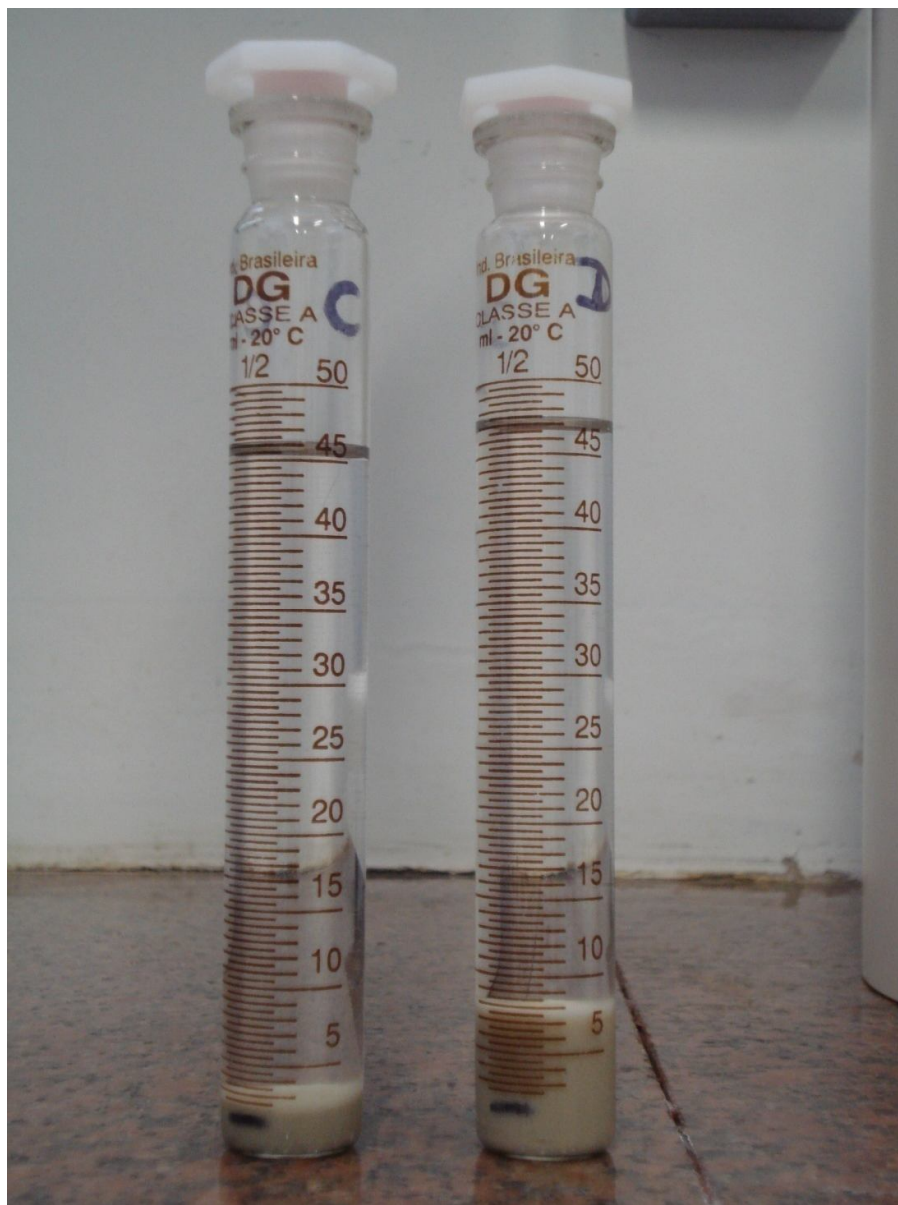
Figura 9 Fotografia do sistema argila/solvente após agitação. A amostra C corresponde a atapulgita natural e a amostra D a atapulgita modificada. As marcações em preto nas provetas indicam os volumes iniciais.
