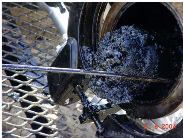
**Figura 3** Limpeza de tubo condutor de petróleo com obstrução da seção interna por depósito de produto parafínico [Petrobras, 2009].
