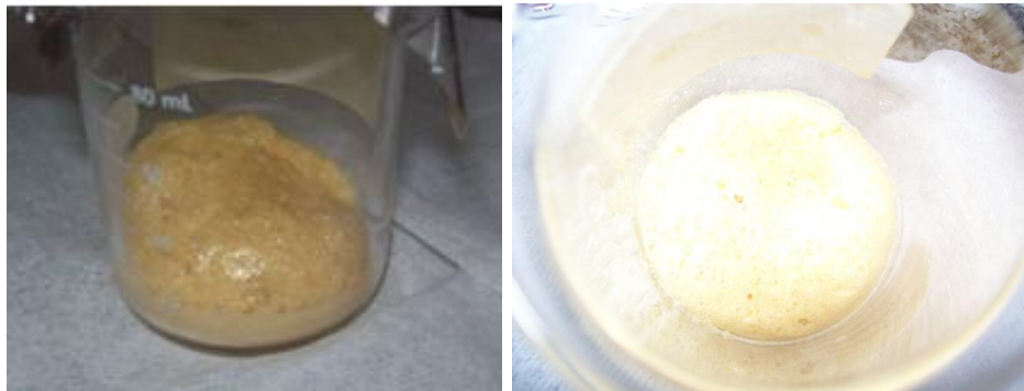
Figura 4.1. Xerogel das amostras produzidas a partir do \text{SiO}_2 , com tratamento térmico de 100^\circ\text{C}/24\text{h} .
