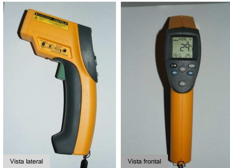
**Figura 7.** Vista lateral e frontal do termômetro infravermelho digital utilizado para aferição da temperatura de pelame.
