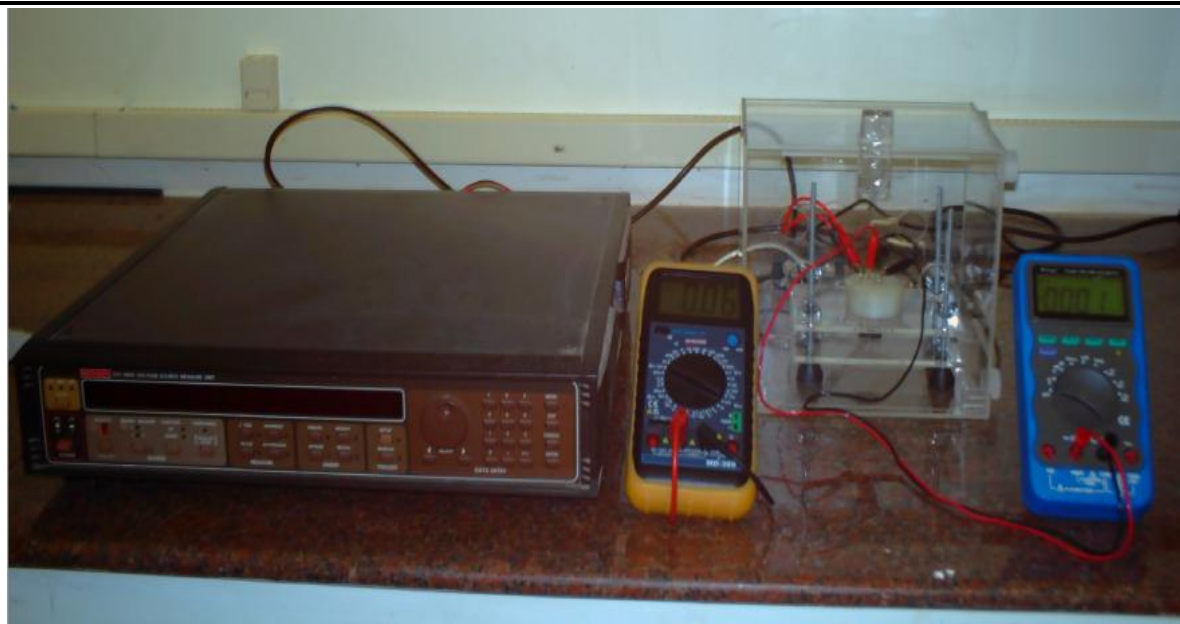
Figura 23. Montagem do método quatro pontas acoplado a um Eletrômetro Keithley 237.
