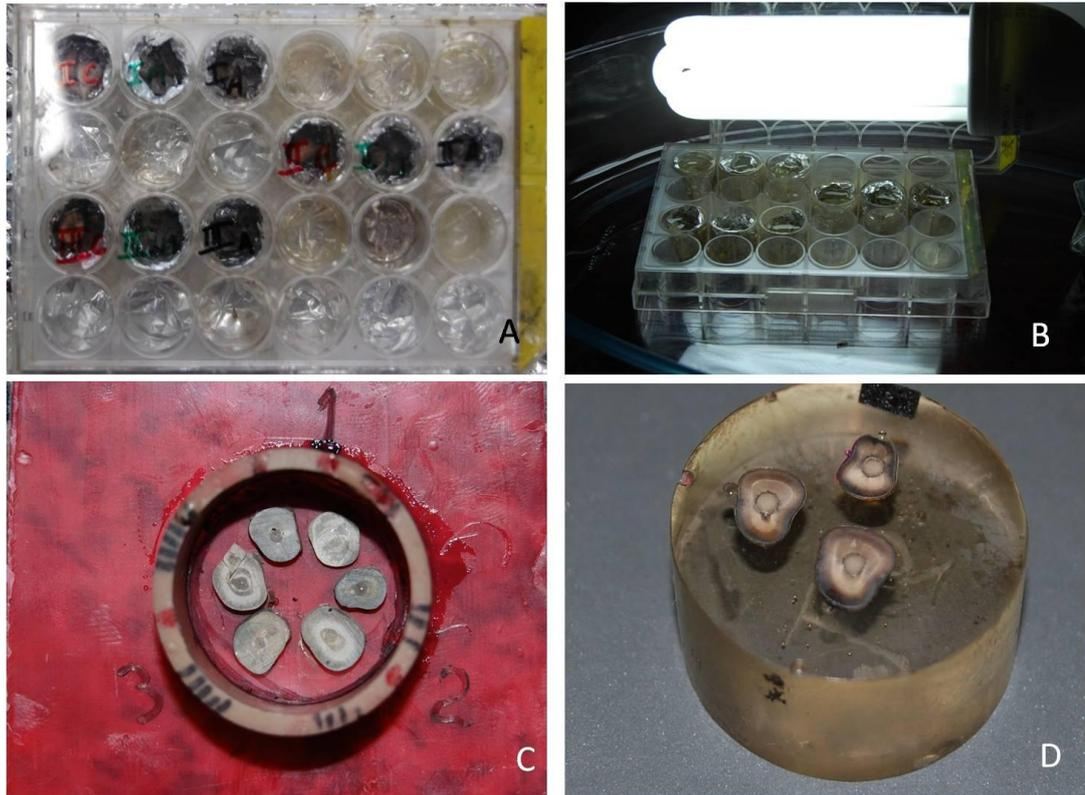
Figura 14- A- Corpos-de-prova submersos em nitrato de prata amoniacal 50%. B- Iluminação fluorescente direta por meio de uma luminária; C- Preparo para a inclusão. D- Amostra incluída em resina de poliestireno.
