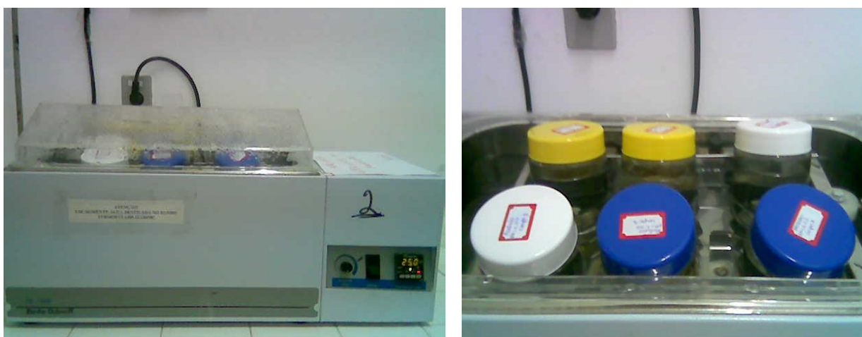
Figura 10- Ilustração do banho termostático (esquerda) e do esquema montado durante a realização do experimento (direita).
