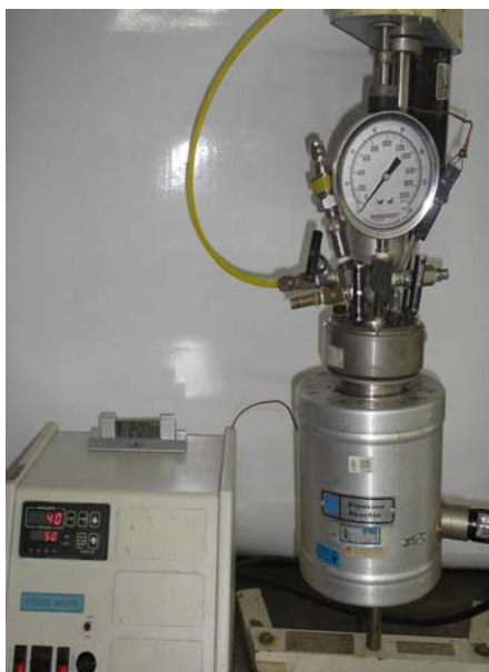
Figura 12. Reator de aço inoxidável utilizado para reações de polimerização e copolimerização.
