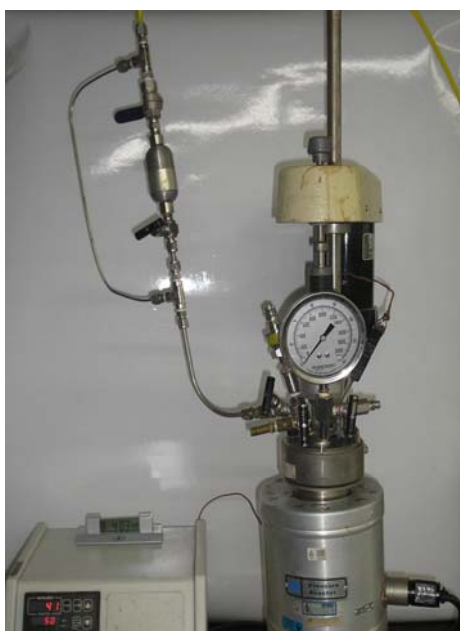
Figura 13. Reator de aço inoxidável, utilizado para as reações de polimerização e copolimerização, com a ampola de adição.
