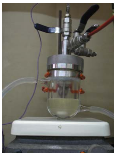
Figura 11. Reator de vidro utilizado para reações de oligomerização.
