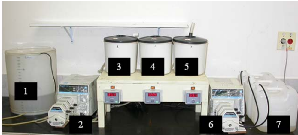
Figura 1. Sistema de tratamento de efluente de fábrica de papel reciclado utilizado neste trabalho: (1) Recipiente do afluente, (2) Bomba peristáltica para bombeamento do afluente, (3) Reator 1 - condição mesófila, (4) Reator 2- condição termófila, (5) Reator 3- condição termófila, (6) Bomba peristáltica para bombeamento do efluente tratado, e (7) coletores dos efluentes tratados.
