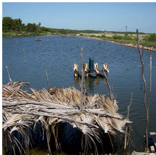
Figura 16 e 17 – Sistema de aeração (pulverização) adotado nas fazendas de camarão, Fortim-Ce, 2005.
