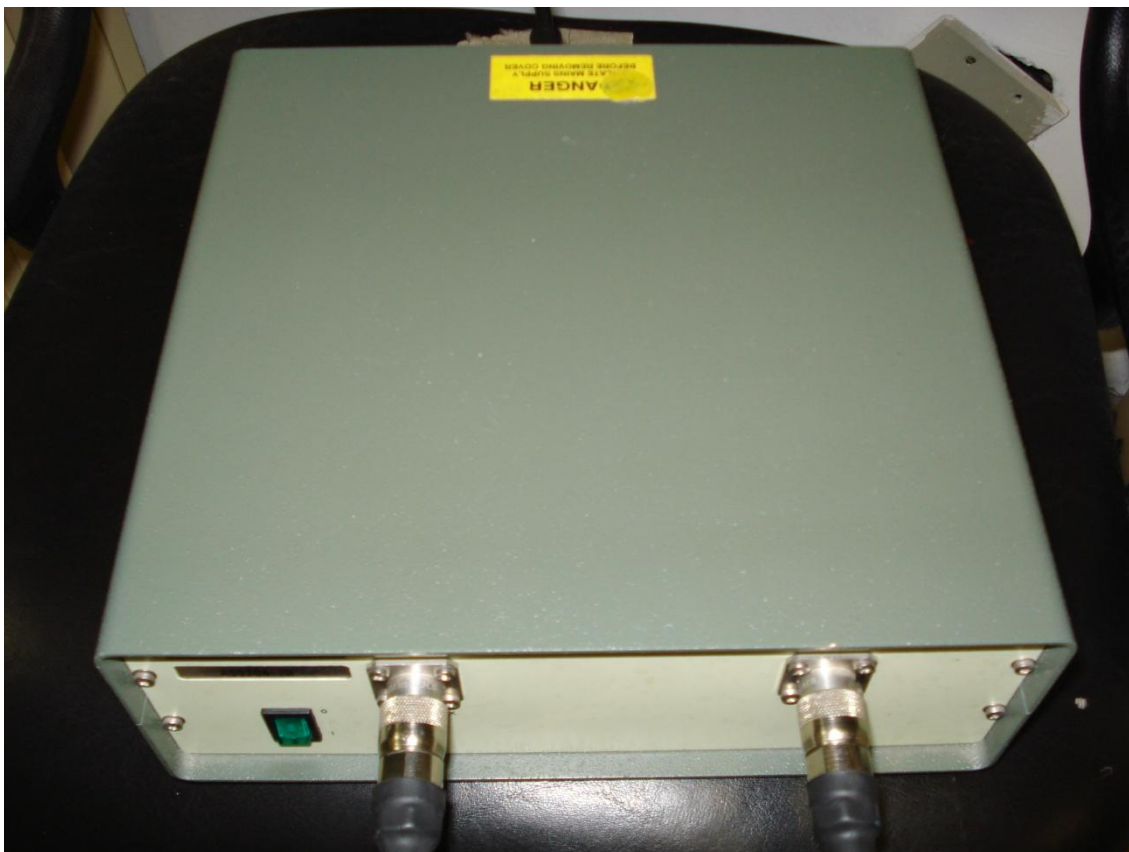
Figura 5.5 – Amplificador Milmega AS0204-7B 2-4GHz 7W
