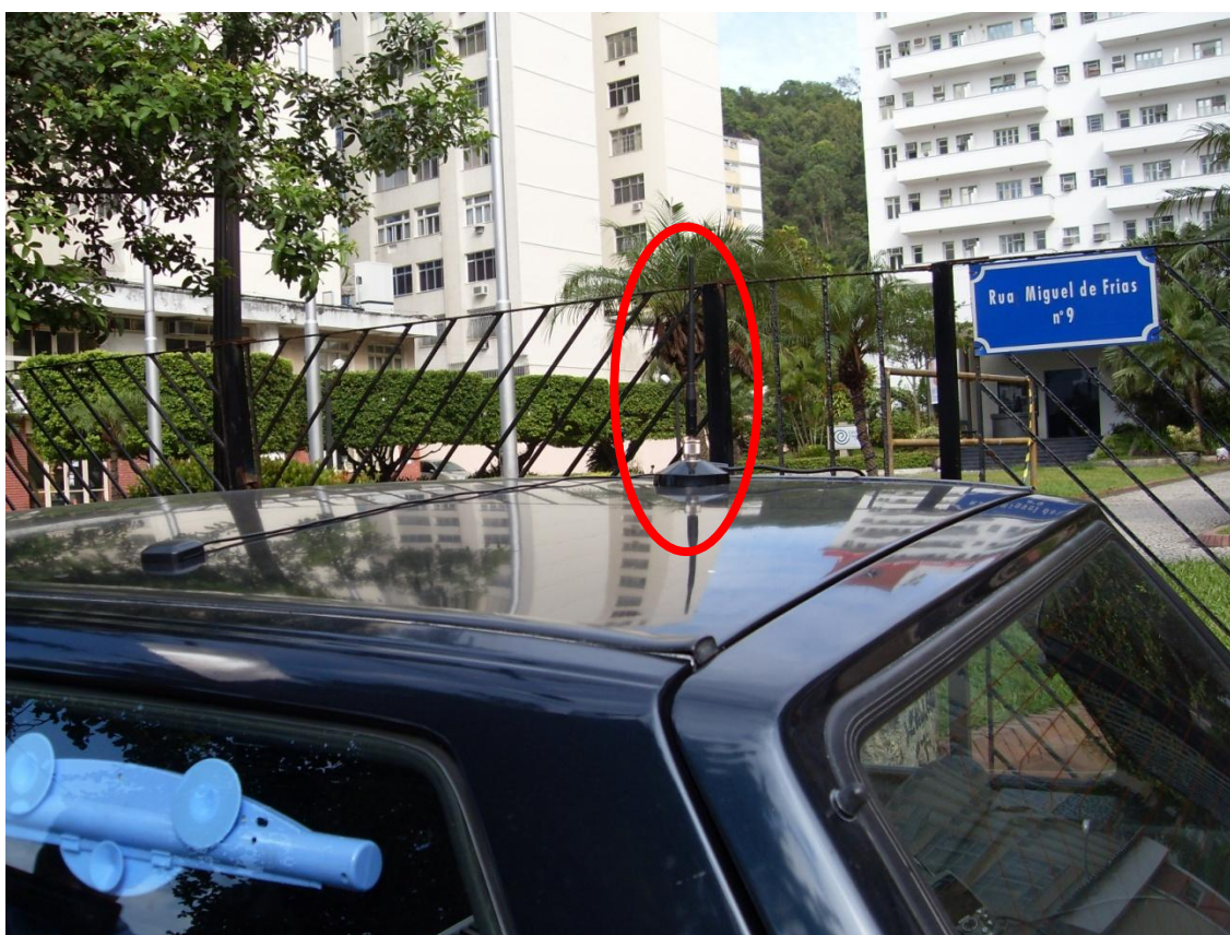
Figura 5.12 – Antena de recepção onidirecional Rubber Duck da Hyperlink
