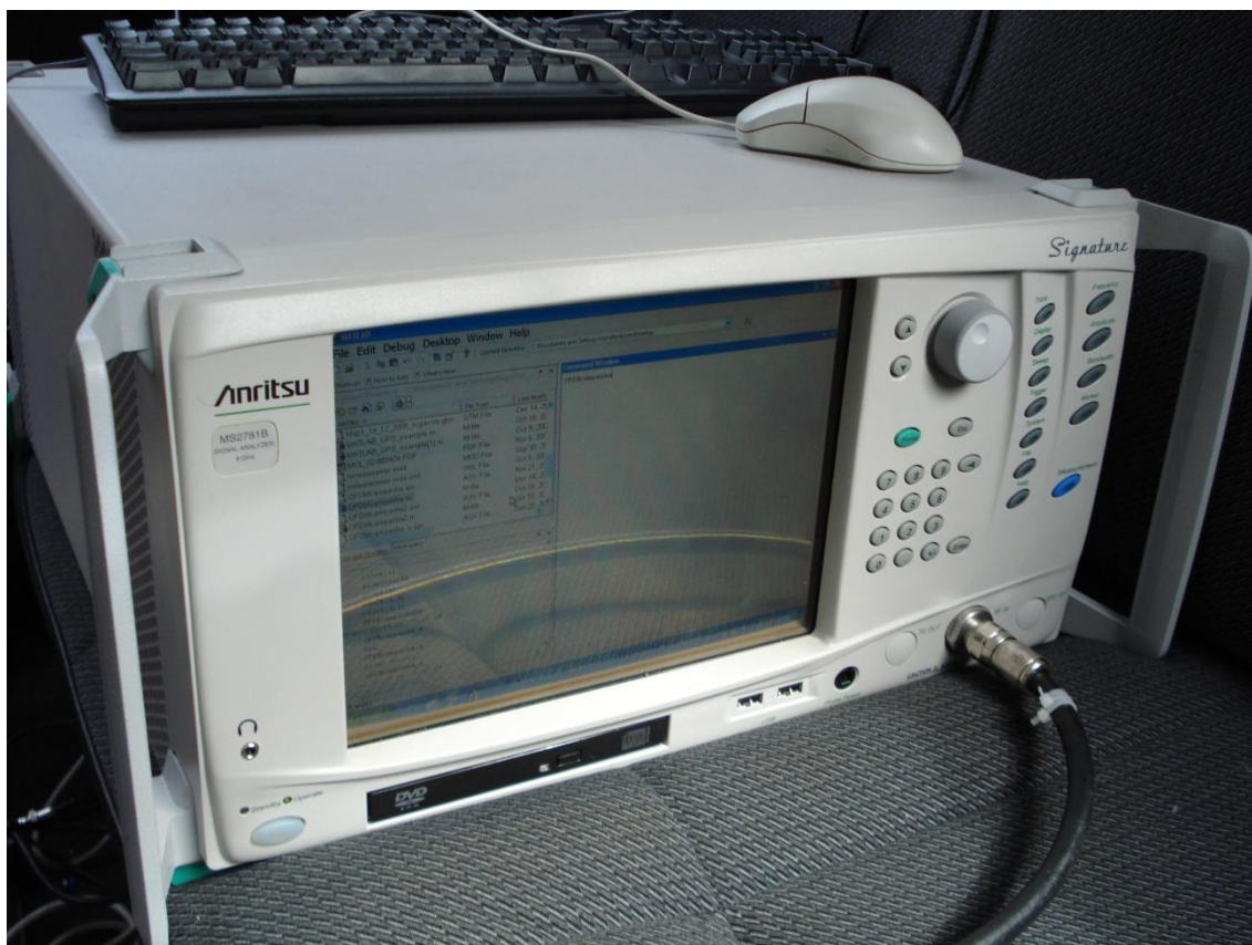
Figura 5.10 – Analisador de espectro MS2781B Signature Anritsu
