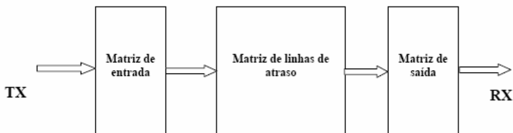
Figura 4.3 – Estrutura Geral do Canal SUI
