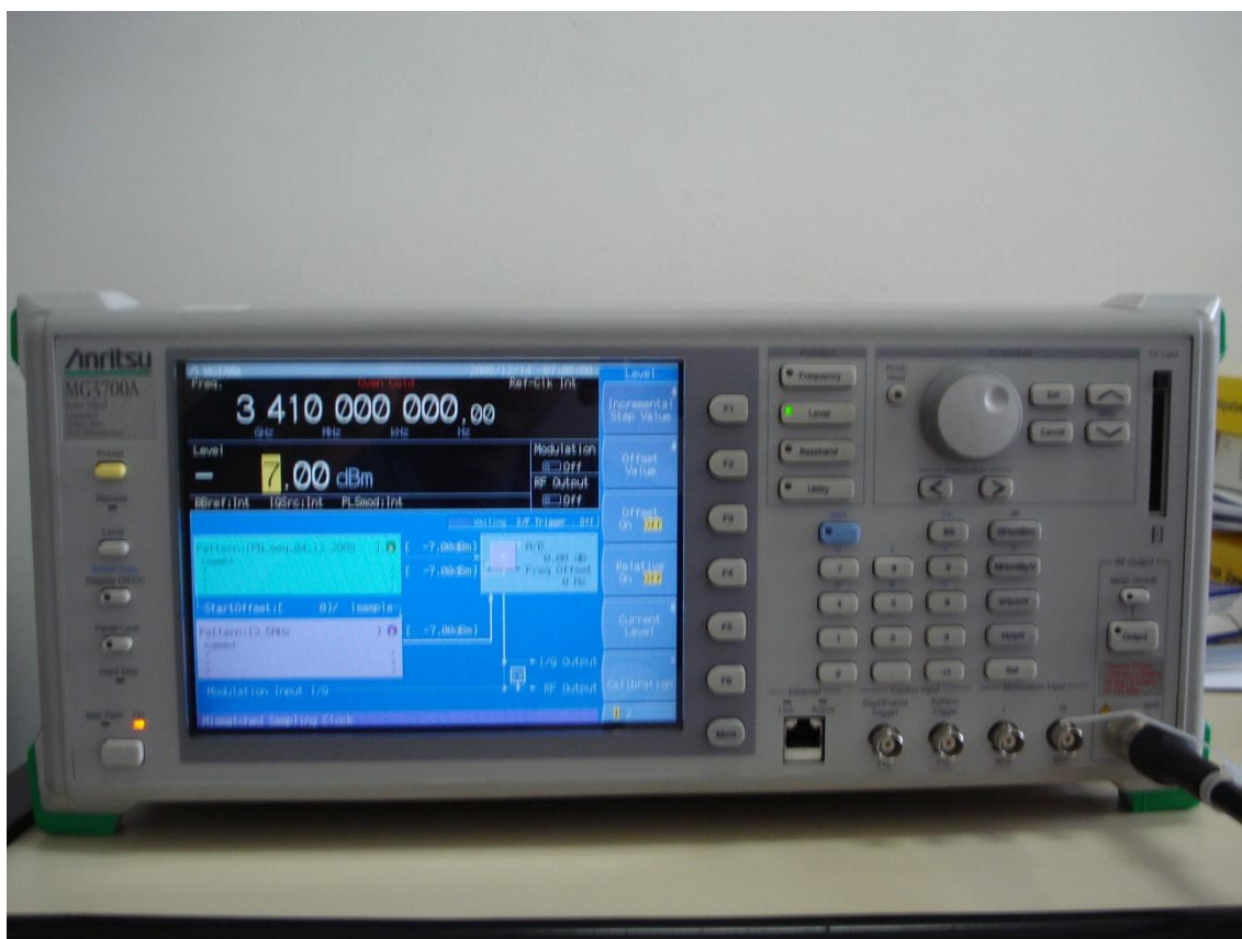
Figura 5.4 – Gerador de sinais MG3700A Anritsu
