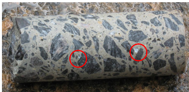
Figura 38: Poros do concreto preenchidos com material de reação
