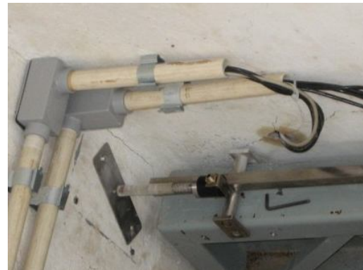
(d) LVDT fixo na barra invar
