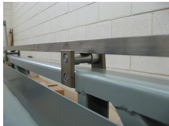
(d) Detalhe do rolete ajustável verticalmente e com ranhura para alinhar a barra
