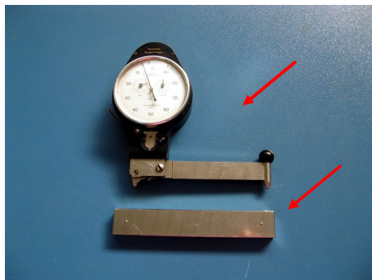
Figura 53: Aparelho de leitura e gabarito de instalação das BT
