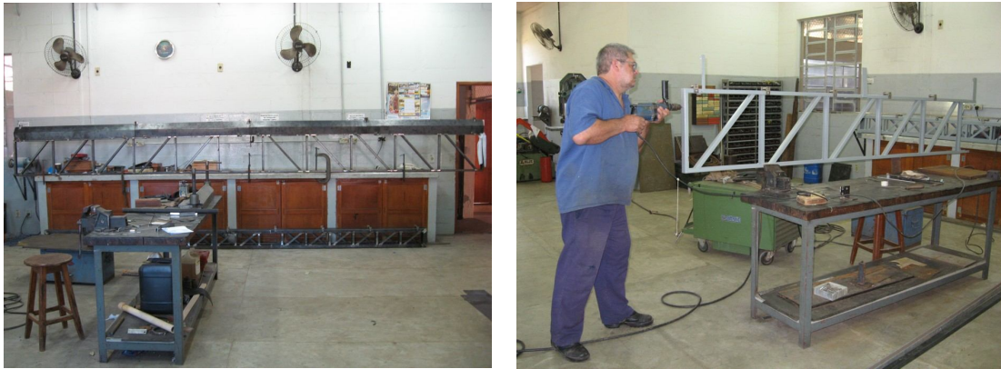
Figura 78: Confeção da viga metálica treliçada
