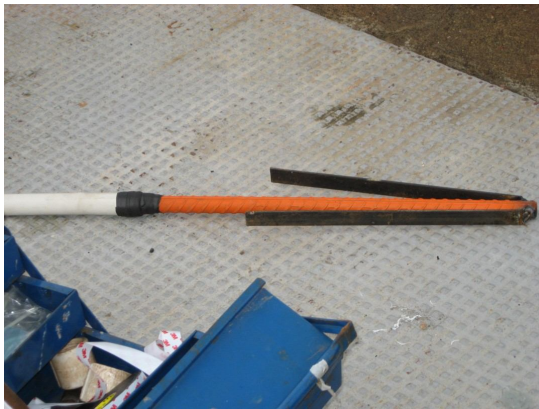
(a) Chumbador das hastes fixo no PVC
