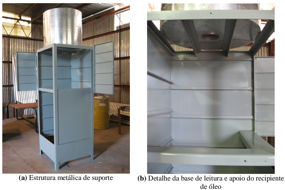
Figura 63: Estrutura de suporte e proteção do pêndulo invertido
