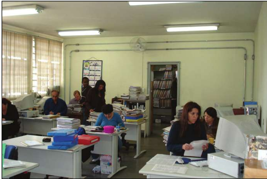
Fig. 4.15. – Caixilhos do cartório (face norte) com persianas, para impedir a entrada direta da luz solar nas mesas de trabalho que, conseqüentemente aquece o ambiente.
