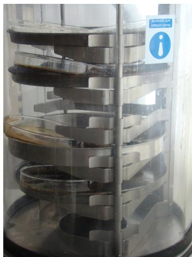
Figura 3.2 – Liofilizador
