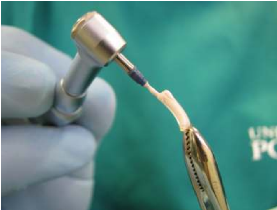
Fig 4 – Demonstrando a inserção dos cimentos nos tubos de polietileno
